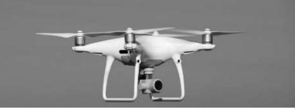
वजनाने हलक्या पण मजबूत घटकांचा बनलेला असतो. या फ्रेम वरती मोटर्स, वायरिंग, इलेक्ट्रॉनिक उपकरणे बसविलेले असतात.
